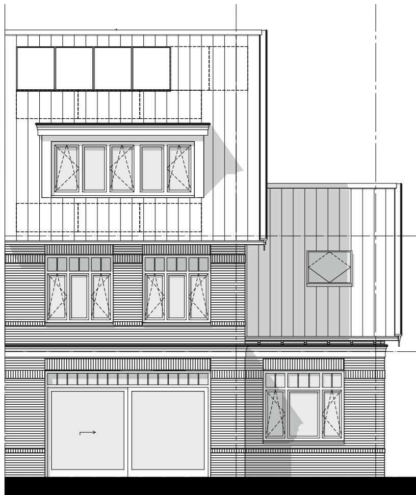
V0.EO0.414 schuifpui V2.EO2.83.5 grote dakkapel V0.IV0.523 tuinkamer V0.EO0.262.2 uitbouw 1.2m V1.EO1.140 extra dakraam #optie maximaal aantal zonnepanelen icm dakkapel
