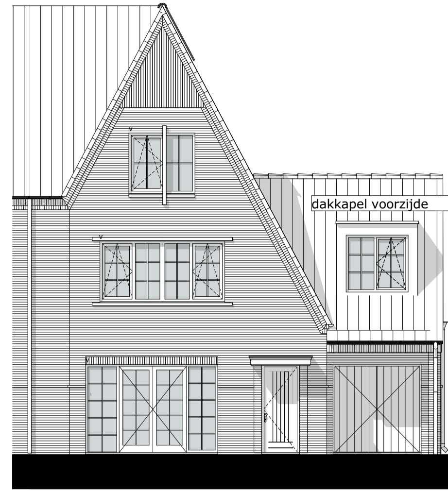
1:100 Voorgevel dakkapel voorzijde
